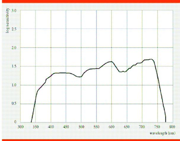
La sensibilité est la réciproque de l'exposition (mJ/m<sup>2</sup>) nécessaire pour produire une densité diffuse de 1,0 au-dessus du brouillard.
